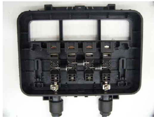
Fig. 5: Caja de conexiones
